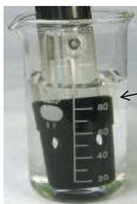
標準液に電極プロテクトキャップ全体が完全に沈み、かつローレットネジが沈まないように入れてください。
