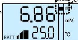
※電源“ON”の状態では、pH電極の先端部が空气中、検水中のどちらにあるかは関係なく、常に自動で安定判断を行います。
