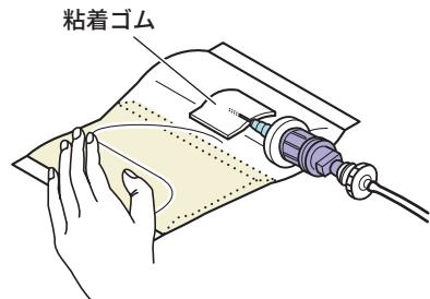
3. 袋の片側を手で軽く押さえ、注射針をサンプルガス中にセットします。
