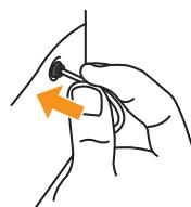
2. 新品のフィッティング付サンプリングチューブを取り付けます。
