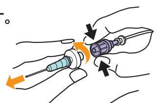
2. フィッティング付サンプリングチューブから、チェックバルブを取り外します。
