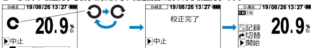
校正值は電源を"OFF"したり、電池・ACアダプターを外しても保持されます。
